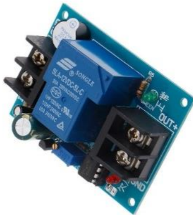
ภาพที่ 6 อุปกรณ์ป้องกันแรงดันตกขนาด 12V
