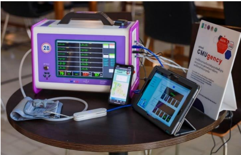
ภาพที่ 12 เครื่องวัดสัญญาณชีพพื้นฐานพร้อมการสื่อสารแบบไร้สาย (CMUgency) รุ่นที่ 2
