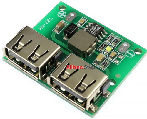
ภาพที่ 7 วงจรแปลงแรงดัน 5V เป็น USB port คู่
