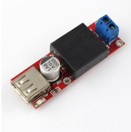
ภาพที่ 11 วงจรแปลงแรงดัน 5V 3A เป็น USB Port เดี่ยว
